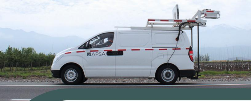
APSA es la primera empresa en Latinoamérica en adaptar un sistema de inspección y proceso automatizado de los deterioros superficiales con tecnología láser LCMS, logrando adaptar el sistema según las metodologías de inspección visual de cada país.
