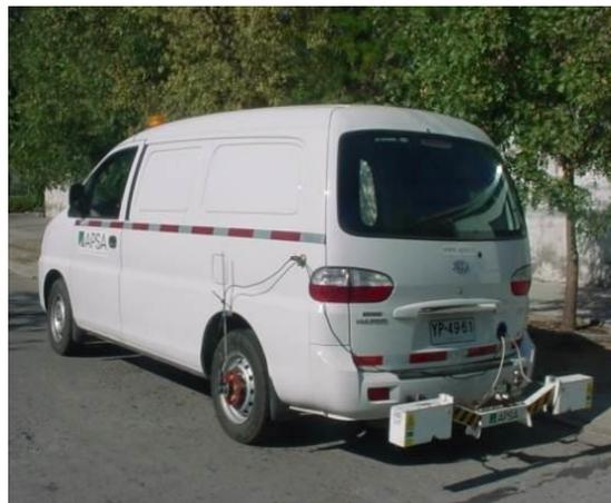
Fotografía1 Equipo perfilómetro laser.
