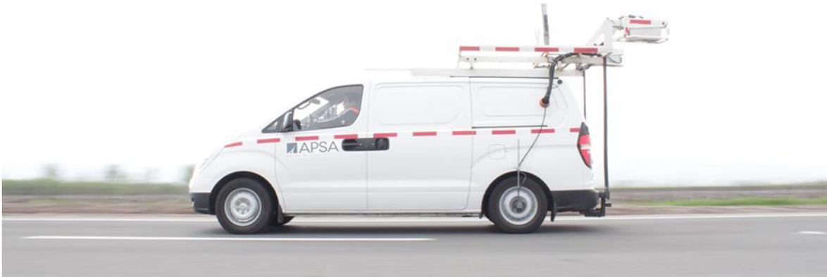
Fotografía 2 Equipo Laser Crack Measurement System.
